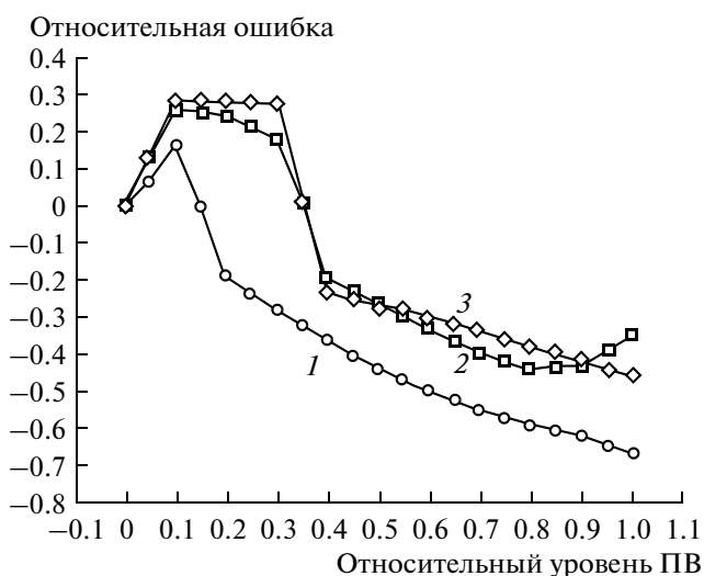
Рис. 6. Относительная ошибка приближения нормальной ПВ в случае сильной корреляции ( r_{1,2} = r_{2,3} = 0.8; r_{1,3} = 0.6 ): K = 0 (1); 2 (2); 5 (3).
